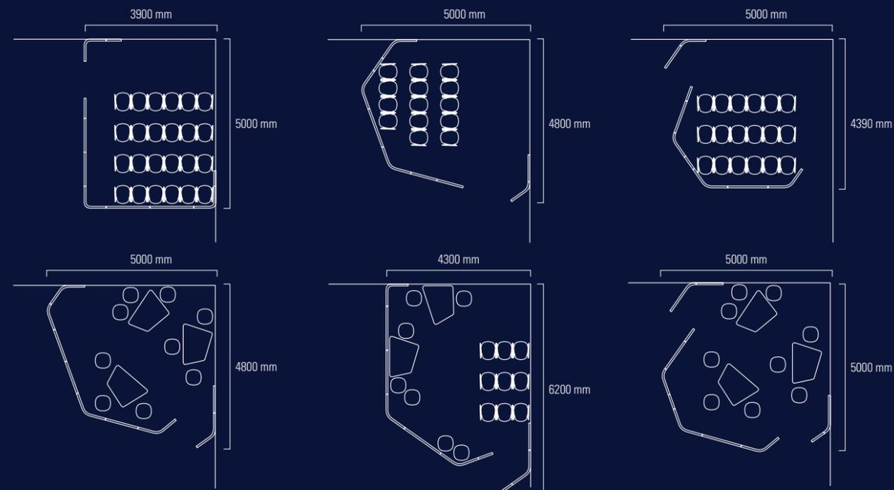
Der abgerundete Abschluss verjüngt sich nach unten. So entsteht eine Öffnung, die sich am menschlichen Körper orientiert: oben breiter und unten schmaler. Dank der speziellen Geometrie der Module, 125°-Winkel statt 120°, wird eine organische Form der Konstruktionen ermöglicht, wobei es keine parallel stehende Wände mehr gibt und der Eingang bei Raum-in-Raum-Aufbauten einladend schräg gesetzt ist.
